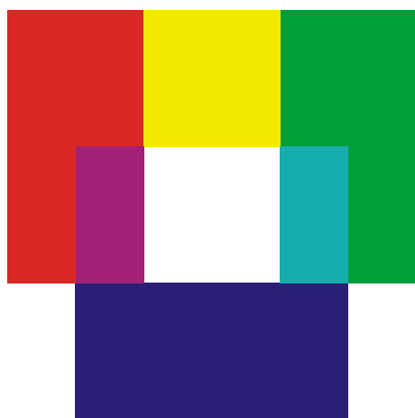
Obr. 22.7: Aditivní skládání barev
