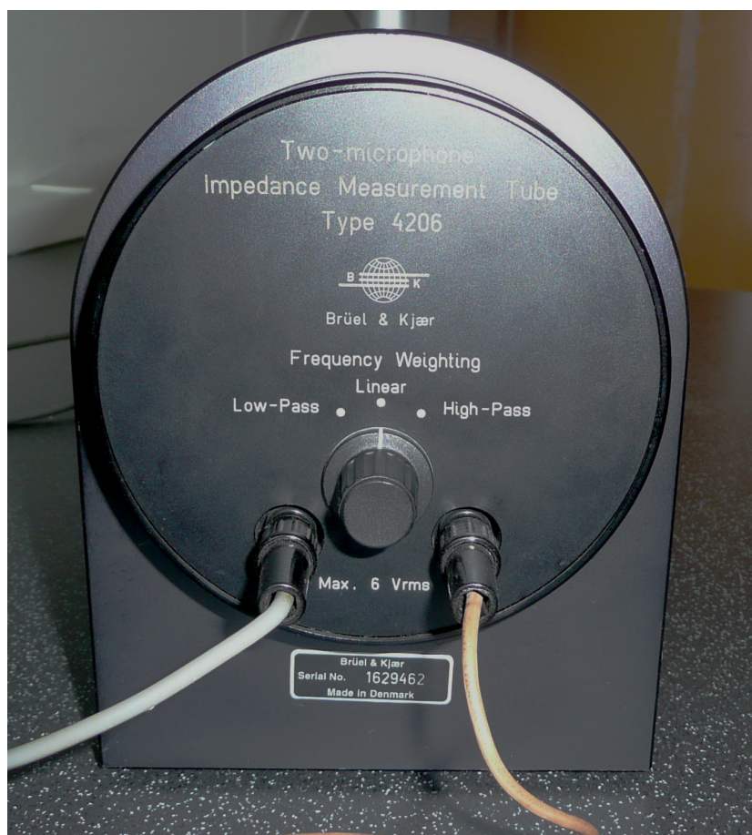
Obr. 5: Boční pohled na Kundtovu impedanční trubici.
