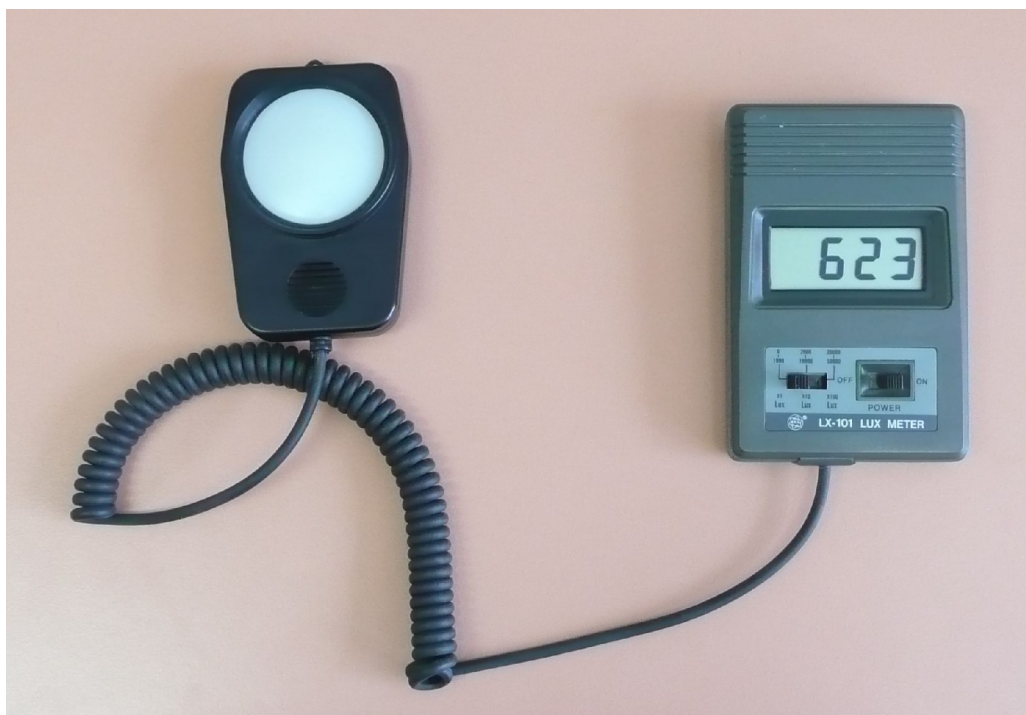
Obr. 2: Digitální luxmetr LX-101.
