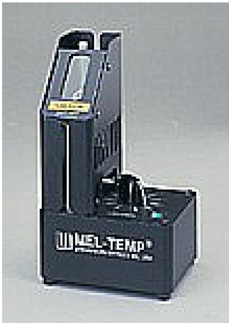
Obrázek 1: Komerční aparatura MelTemp pro měření bodu tání prášků
