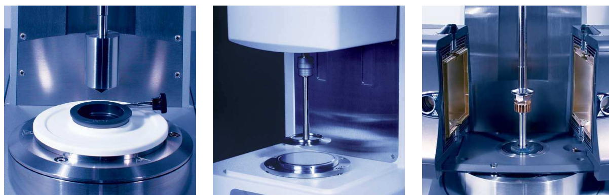
Obrázek 3.6: Geometrie rotačního válce. Válec -válec (vlevo), kužel - deska (uprostřed) a deska - deska (vpravo).
