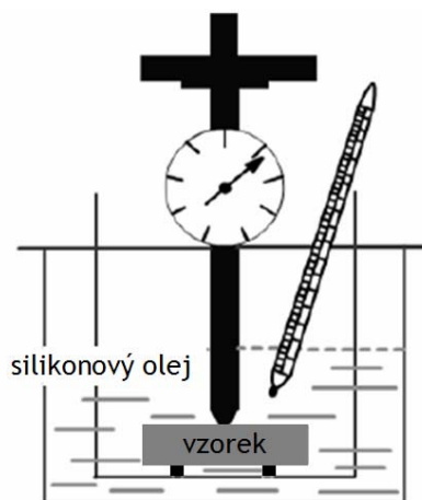
Obrázek 12.2: Schéma metody ISO/R75.
