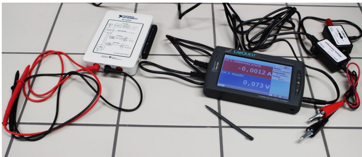
Obr. 8 Měřicí zařízení myDAQ a LabQuest s moduly voltmetr a ampérmetr.
