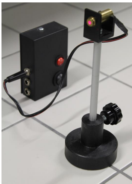
Obr. 5 Modul červeného laseru se zdrojem napájení
