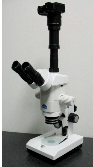
Obr. 5: Stereoskopický mikroskop STM 1562 se stativem umožňujícím horní, spodní osvit a fotoaparát na trinokulární hlavici.
