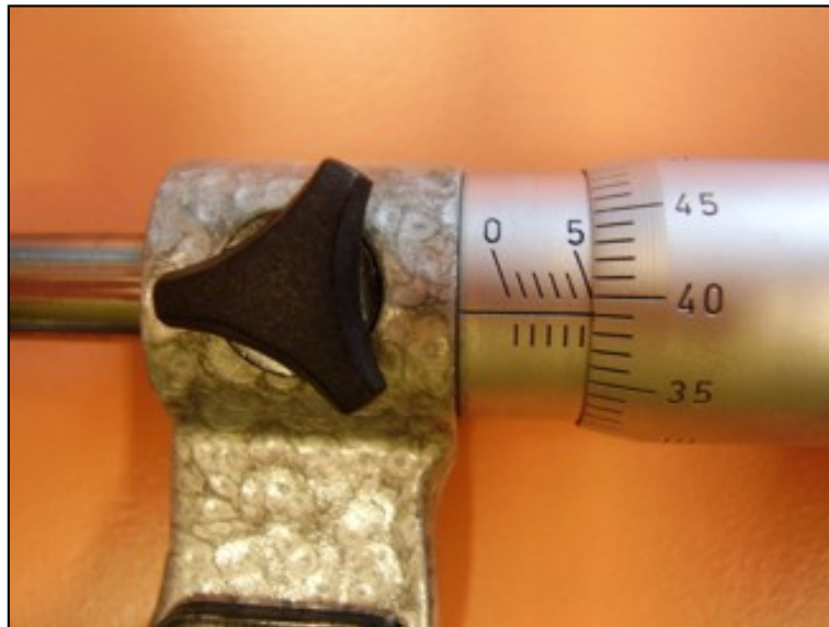
Obr. 5 Detail stupnic na mikrometru
